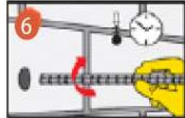
Durante el tiempo de endurecimiento del adhesivo, el ancla no debe ser movida o cargada, se debe de esperar hasta el tiempo de curado. Limpiar inmediatamente las herramientas con **Sika® Limpiador**. El **Sika® AnchorFix-1** una vez que ha endurecido solo puede retirarse por medios mecánicos. Lavar manos y piel con agua y jabón.
