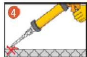
Inyectar inmediatamente después el adhesivo en la perforación, comenzando desde el fondo y llevando la boquilla hacia atrás progresivamente mientras la perforación se rellena. Evitar la inclusión de aire. Para anclajes profundos, puede utilizarse un tubo o manguera de extensión.
