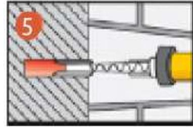
Insertar el ancla con un ligero movimiento de rotación en la perforación rellena con adhesivo. Un poco de adhesivo debe salir de la perforación como excedente. El ancla debe siempre ser colocada durante el tiempo de gelado del material.
