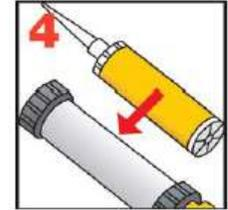
Cuando se interrumpa un trabajo, la boquilla mezcladora puede permanecer en el cartucho una vez que se libere la presión de la pistola de aplicación. Si la resina ha endurecido en la boquilla cuando se reanude el trabajo, una nueva boquilla debe utilizarse.
